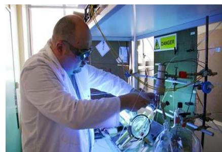
**Réacteur d'épuration catalytique de l'eau**
