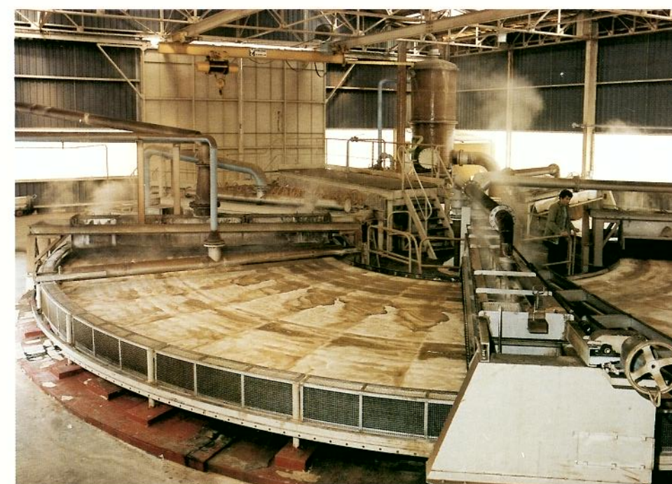
Le filtre UCEGO, pièce maîtresse de l'atelier phosphorique sépare l'acide du gypse.
